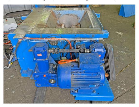
Wir bieten Ihnen hiermit einen gebrauchten PET Flaschen crusher des Herstellers BOREMA, Typ R-1200 F, Baujahr 2013, zur Restentleerung, Entlüftung und Vorverdichtung der aufgegebenen PET-Flaschen, von 0,3 bis 2,5 I Inhalt an. Die Maschine verfügt über ein Fahrwerk und kann in den Einwurfschacht ihrer Ballenpresse hinein und wieder hinausgefahren werden. Die Maschine hat eine Durchsatzleistung von ca. 85.000 Flaschen, entsprechende ca. 3 t pro Stunde.
