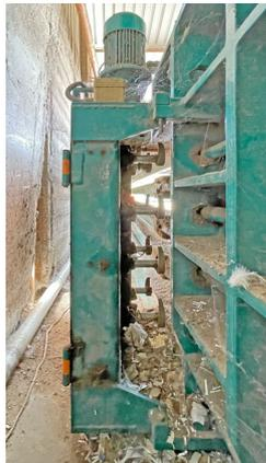
**Ballenpresse Klanke, Typ KBST 80, 80 t Presskraft, Baujahr 2008, Antrieb 2 x 30 kW, mit 4-fach Horizontalabbindung, mit defektem Kettengurtförderer**
