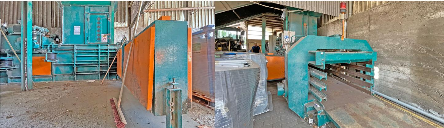
**Ballenpresse Klanke, Typ KBST 80, 80 t Presskraft, Baujahr 2008, Antrieb 2 x 30 kW, mit 4-fach Horizontalabbindung, mit defektem Kettengurtförderer**
