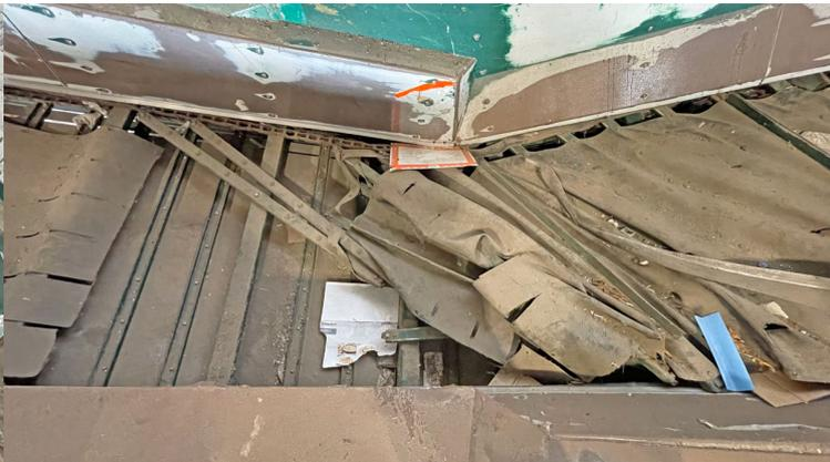
**Ballenpresse Klanke, Typ KBST 80, 80 t Presskraft, Baujahr 2008, Antrieb 2 x 30 kW, mit 4-fach Horizontalabbindung, mit defektem Kettengurttföhrer**
