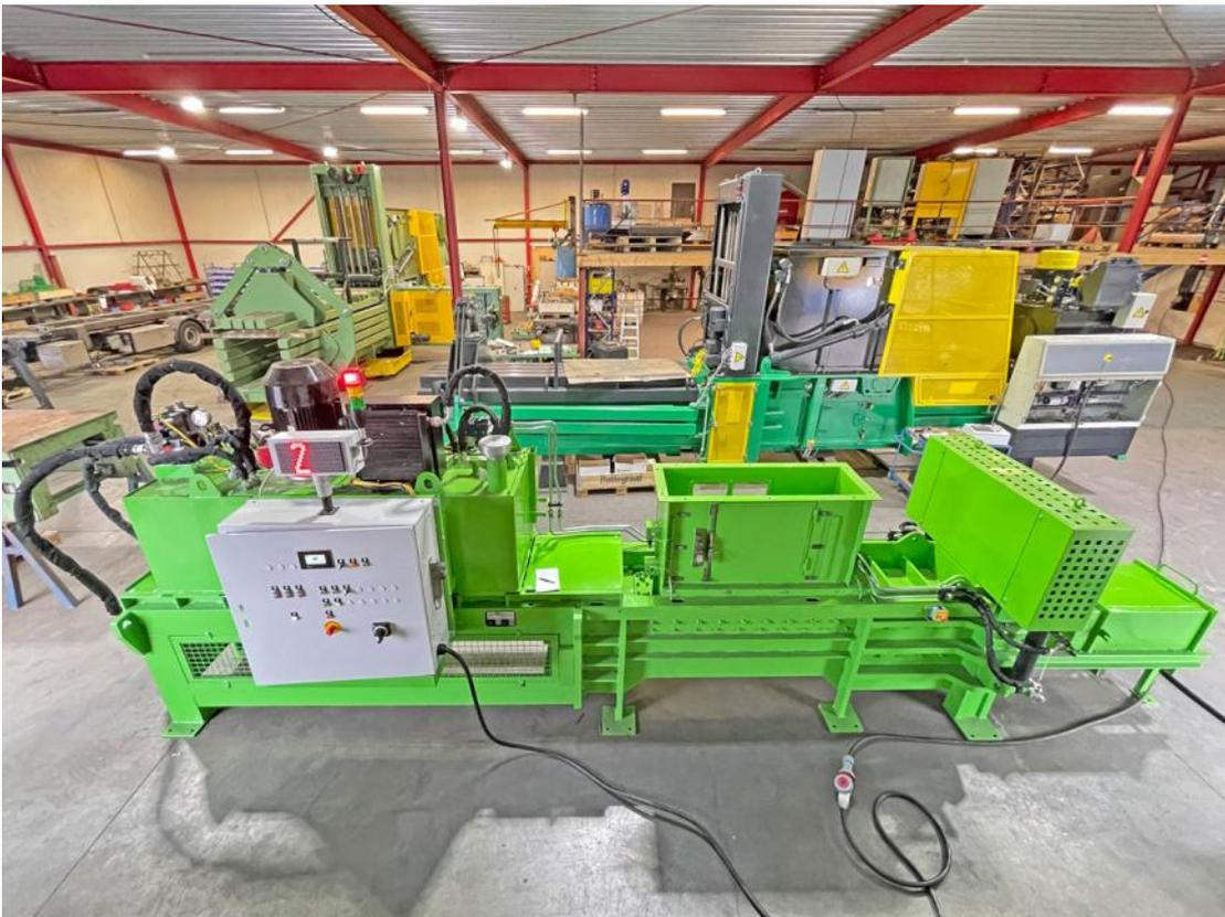
Diese Maschine ist laut Hersteller zum Pressen von Blechdosen, Blechverschnittresten, Stahlblech sowie Aluminium-, Messing- und Kupferabfällen geeignet und wurde in unserer Werkstatt komplett überholt.
