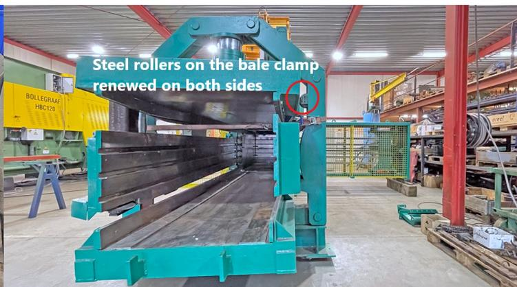
**Ballenpresse MACPRESSE, Typ 111A, 170 t Presskraft, Baujahr 1996, Antrieb 2 x 55 kW, inkl. Kettengurtförderband und Drahtzugstationen, Presse überholt**
