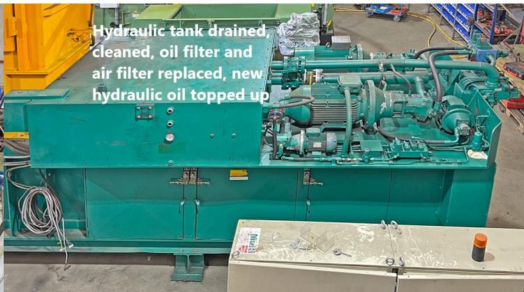
**Ballenpresse MACPRESSE, Typ 111A, 170 t Presskraft, Baujahr 1996, Antrieb 2 x 55 kW, inkl. Kettengurtt Förderband und Drahtzugstationen, Presse überholt**
