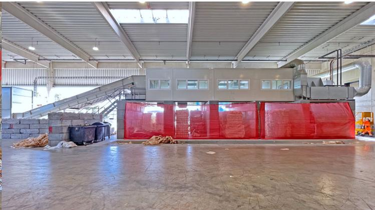
**Sortieranlage für Gewerbeabfälle, Papier, Karton, Kunststoff, in Modulbauweise, Baujahr 2022, 151 Betriebsstunden, Sortierleistung bis zu 20.000 t/Jahr**
