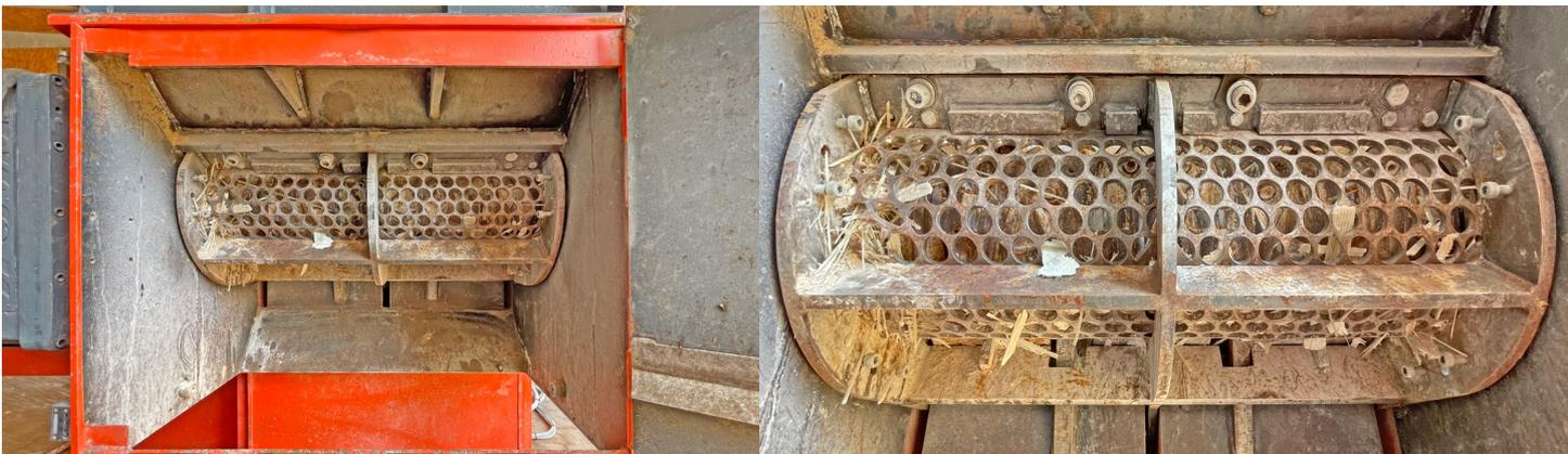
**Einwellenzerkleinerer WEIMA , Typ WLK 800, Baujahr 2018, nur 1.192 Betriebsstunden, Antriebsleistung 30 kW, profilierter V-Rotor 800 x 260 mm**
