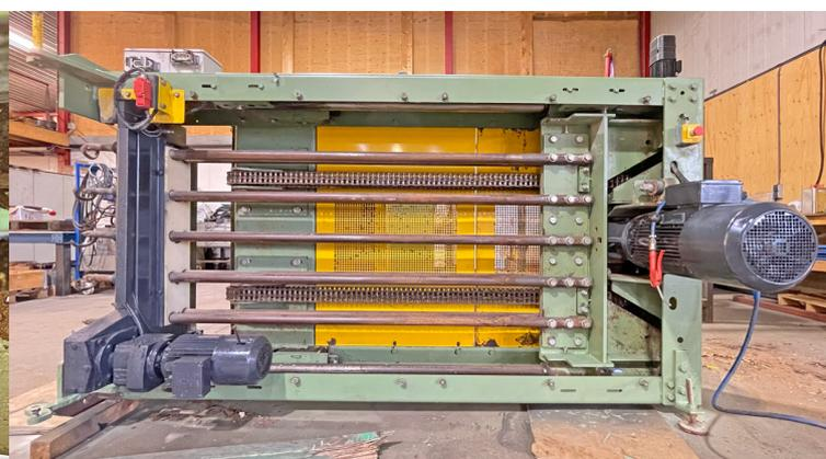
**Ballenpresse Bollegraaf, Typ HBC 110 K / 75 kW, 100 t Presskraft, Baujahr 2007,
