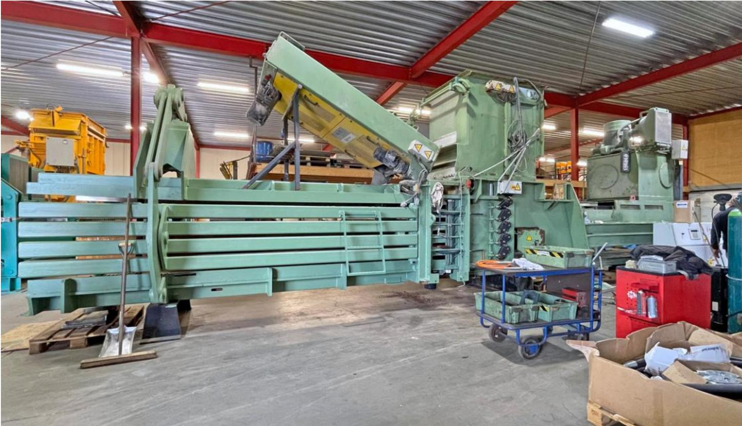
Die Presse wird aktuell in unserer Werkstatt überholt. Auf den Fotos sehen Sie deshalb die in Teilen demontierte Maschine, wo einzelne Baugruppen und Zylinder fehlen. Diese werden nach den Überholungsarbeiten wieder montiert und die Presse im manuellen und automatischen Modus getestet. Wir gehen davon aus, dass die Maschine im November einsatzbereit sein wird.
