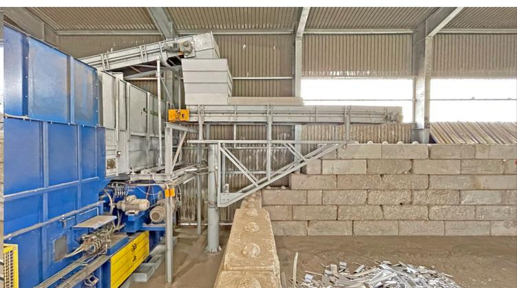
**Sortieranlage, Bj 2009, Erweit. 2015, Sortierleistung 25.000 t/Jahr, mit TiTech Autosort 4, 10 Sortierplätzen, 150 t Ballenpresse, Containerverladestation**
