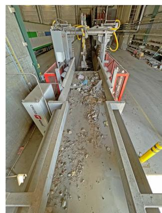
**Cross Wrap Ballenöffner Linie für RDF/MSW, Papier, Karton, Typ BO 4000, Baujahr 2015, nur 674 Ballen wurden geöffnet, Öffnungszeit 45 Sekunden**
