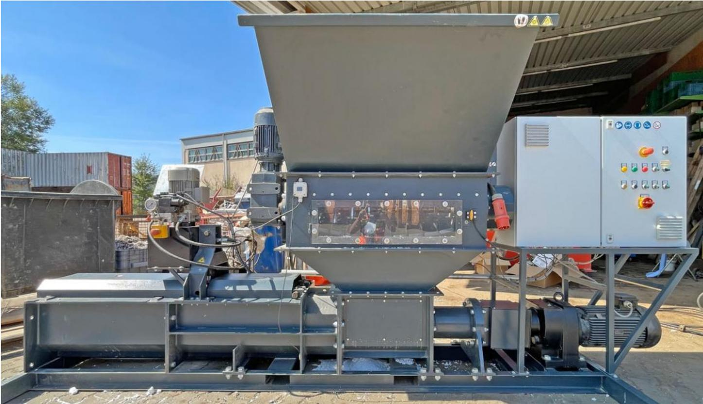
Die Presse war nur sporadisch im Einsatz, ist in einem sehr guten Zustand und kurzfristig verfügbar. Durch das geringe Gewicht der Maschine und die Staplerschuhe im Transportrahmen, ist die Presse mobil, direkt am Anfallort des Materials, auf der Baustelle einsetzbar. Der elektrische Anschluß erfolgt über einen CEE 32 A Stecker.
