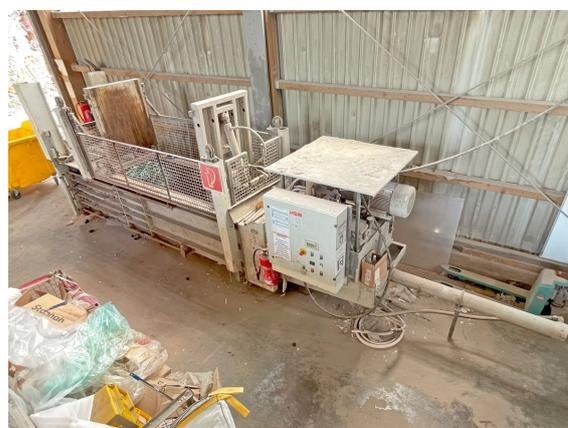
**Ballenpresse HSM, Typ HL 3521 S, 32 t Presskraft, Baujahr 2007, nur 964 Betriebsstunden, Antriebsleistung 22 kW, mit 6-fach Horizontalabbindung, manuell**
