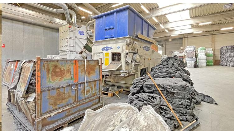
**Einwellenzerkleinerer ZENO, Typ ZTLL 1600 x 2300, Baujahr 2010, 13.727 Betriebsstunden, Antriebsleistung 75 kW, 42 Stück Messer**
